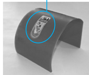
フレキシブル接続技術により作製した フィルム型コネクタの曲面貼り付け例
