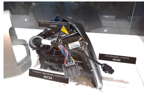
カメラコネクタMX55シリーズ (欧州カーメーカー採用の ドアミラー実機)
