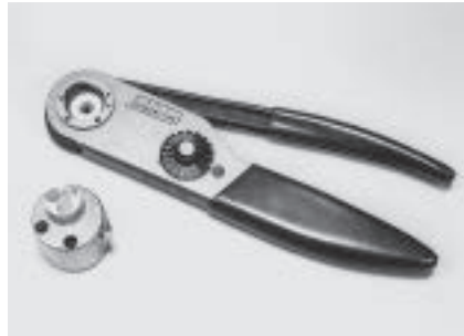
手動式圧着工具:M22520/1-01 ロケータ:TH-185
