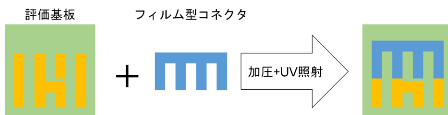
図 2. フィルム型コネクタの接続プロセス
