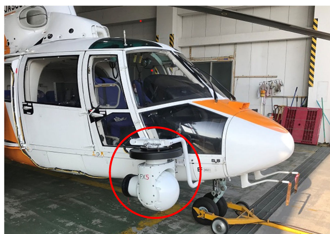
図 2. 4K カメラ内蔵カメラスタビライザ ACE-FX5
