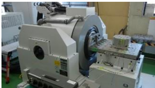
図 8. 振動試験機
