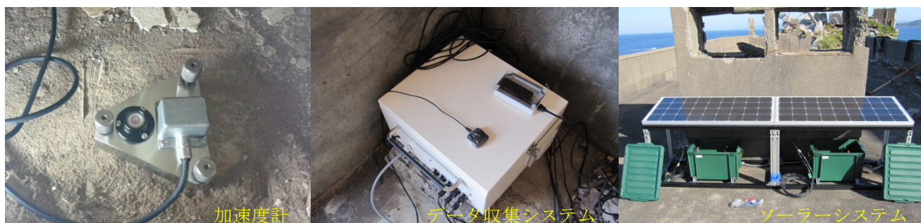
図2. 外観写真(加速度計、データ収集システム、ソーラーシステム)
