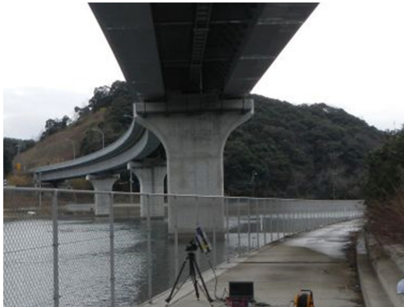
図 3. レーザ変位計設置状況
