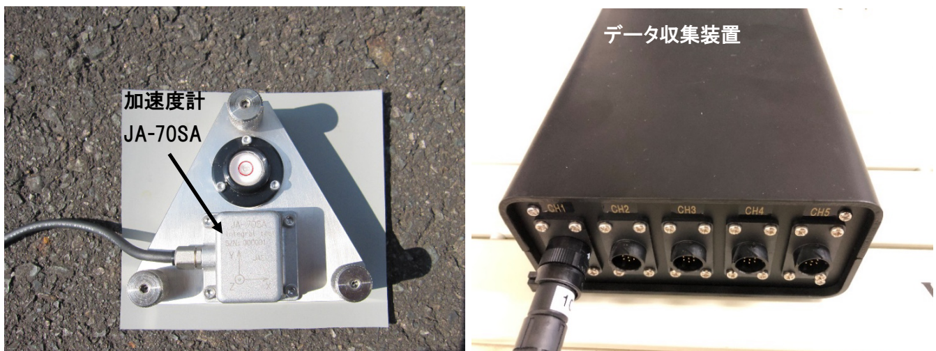
図 2. 加速度計およびデータ収集装置設置状況
