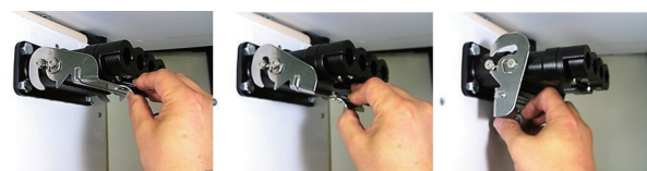
JK11 離脱動作 (ロック部をつまみながらレバーを倒すと離脱)
