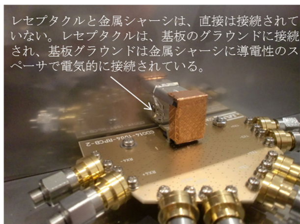
図 10. レセプタクル N (直接接続なし)
