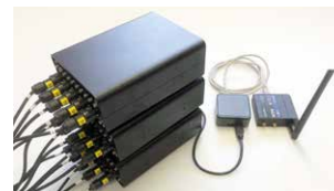
多チャンネル型の橋梁診断計測装置
