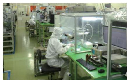
加速度計組立工程
