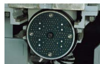
国鉄新幹線用「車両 電気連結器」を開発、 量産開始
